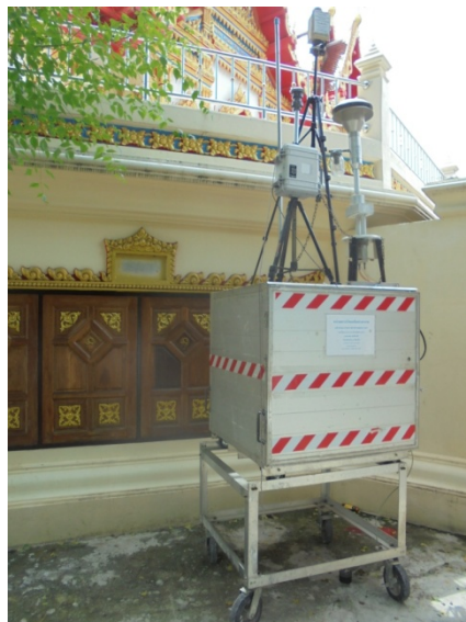
จุดตรวจวัดก๊าซมลพิษ CO SO 2 NO 2 และ HC ตรวจวัดฝุ่นละออง เสียงและแรงสั่นสะเทือน; วัดรบกวนทางเสียง
